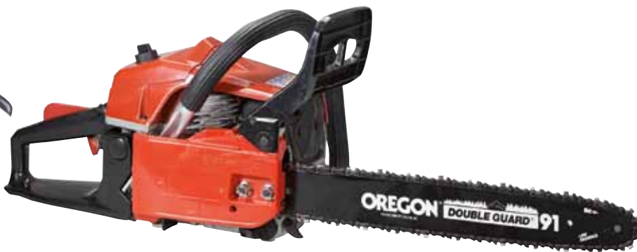
MOTOSEGA A SCOPIO IPCS46 motore 2T con raffreddamento ad aria, potenza 1,8 kW, lunghezza barra 45 cm, barra e catena "OREGON", carburatore Walbro
